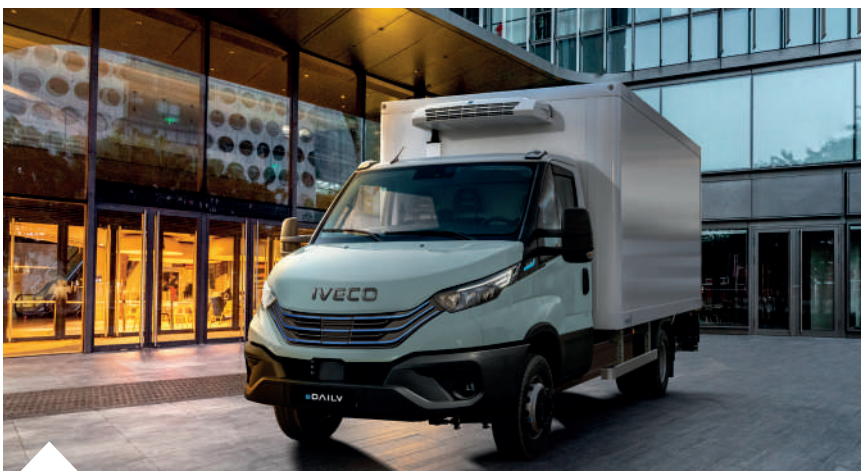
La motorisation électrique s'accommode de toutes les transformations, y compris l'installation de caisses réfrigérées.
